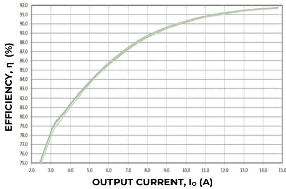
Figure 1. Efficiency  $V_{IN}$ : 240V, Freq: 60Hz
